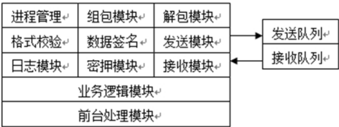
杭州清分机业务迁移系统仿真测试软件功能结构图
